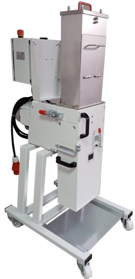
MŁYN W WERSJI LEJA Z POPYCHACZEM ORAZ ZBIORNIKIEM 15 L
