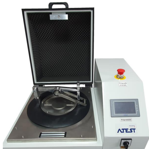
AVM-1 z otwartą komorą i mocowaniem naczynia mielącego
