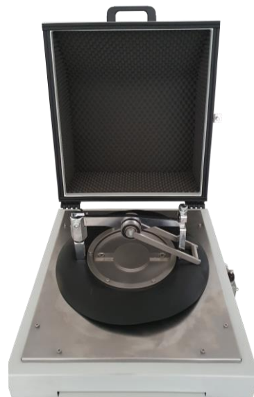
AVM-1.A z otwartą komorą i mocowaniem naczyń mielącego
